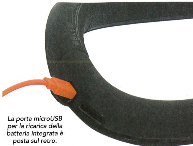
*La porta microUSB per la ricarica della batteria integrata è posta sul retro.*
