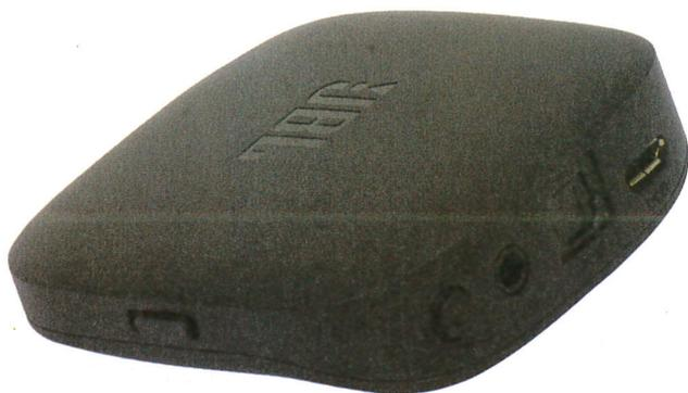
*Il minuscolo trasmettitore Bluetooth incluso nella confezione è fornito di un ingresso analogico su jack audio da 3,5 mm e un ingresso digitale Toslink (solo PCM); un alimentatore USB oppure una porta USB del TV può essere utilizzato per l'alimentazione elettrica. L'interruttore consente di attivare l'ingresso preferito.*
